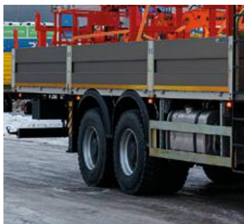
БОРТОВАЯ ПЛАТФОРМА С ЗАНИЖЕННОЙ ПОГРУЗОЧНОЙ ВЫСОТОЙ
