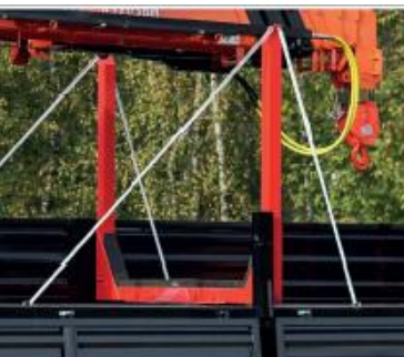
СЪЕМНЫЙ ПОВОРОТНЫЙ КОНИК
